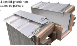
Dettaglio della gronda incassata e del rivestimento in lamiera aggraffata
