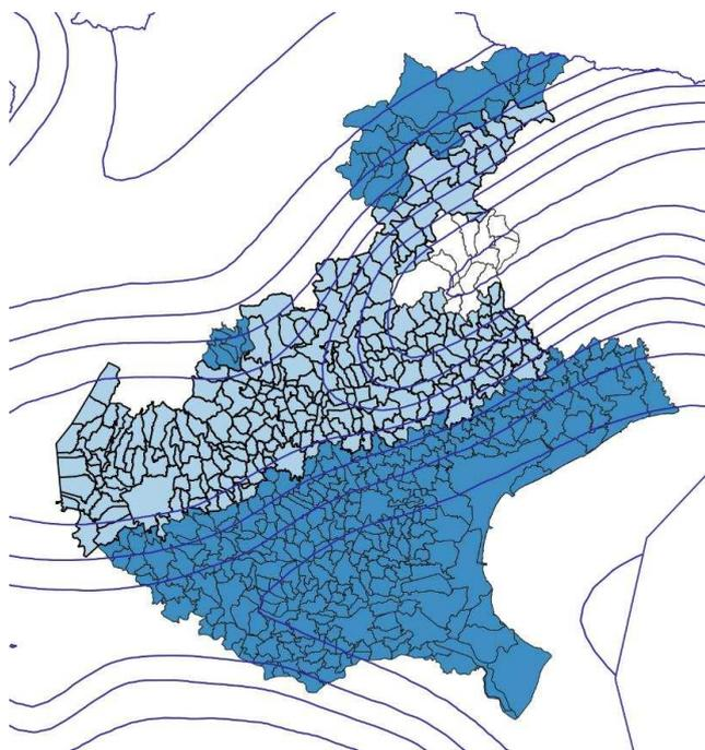
Nuova proposta di zonazione sismica. Le linee blu corrispondono alle fasce di accelerazione sismica contenute nello shape ufficiale della zonazione sismica MPS04 denominato **mps04\_gu\_clip.shp**.
