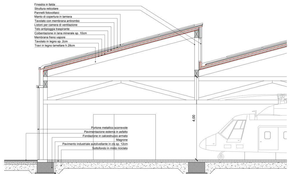
SEZIONE DI DETTAGLIO - HANGAR ELIPORTO - SCALA 1:50
