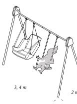
**ALTALENA** Dim: 3.4 x 2 x 2.5 m Materiale struttura: legno FSC Altri materiali: acciaio, corda armata, materiale plastico ad alta resistenza Colore: a scelta
