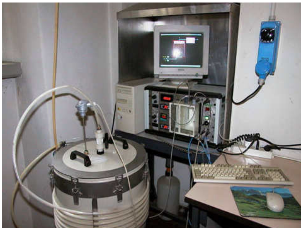
Foto 7 Fermentatore adiabatico utilizzato per la prova di compostaggio
