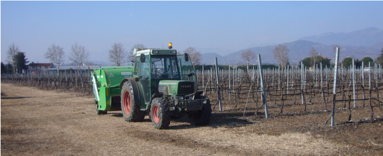
Foto 5 Trincia-raccogliitrice trainata da trattore con camera di trinciatura separata e benna ribaltabile utilizzata nelle prove di raccolta
