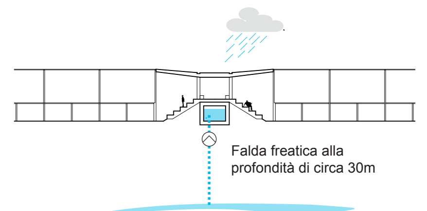
SCHEMA DI SEZIONE SERBATOIO TRIBUNE - SCALA 1:500
